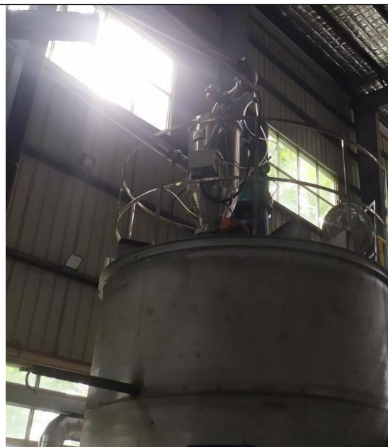
投料工序脉冲布袋除尘器
